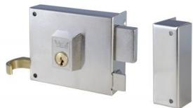
Variante: Cerradura de sobreponer de un punto de cierre 125 con palanca y picaporte, cilindro redondo de 25mm de diámetro longitud 70 mm, entrada de 40mm, caja de 80mm, mano izquierda, acabado hierro pintado.
